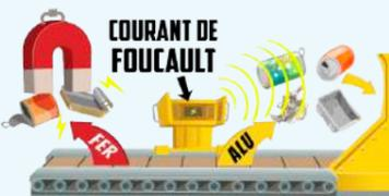
C'est une sorte d'aimant géant très puissant, qui permet de trier les différents emballages métalliques dans les centres de tri. Il repousse tous les métaux qui ne sont pas attirés par un aimant, comme l'aluminium. Ainsi, éloignés par ce champ magnétique, les emballages en aluminium sont facilement séparés du reste. Et ça fonctionne aussi pour le papier d'aluminium, même en morceaux froissés ou en boulettes !
